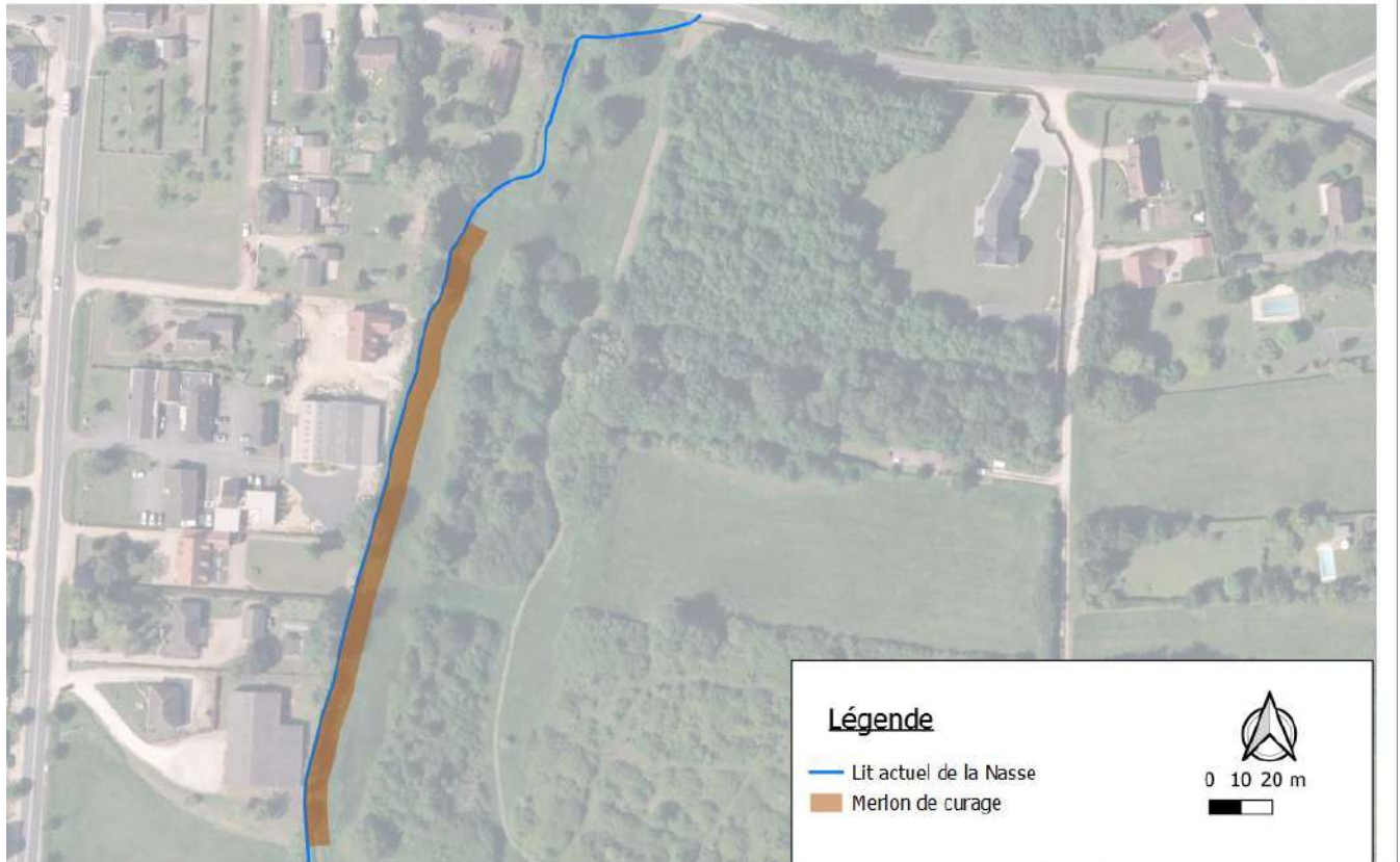
Figure 10 : Merlon de curage à décaisser au droit du cours d'eau de la Nasse
