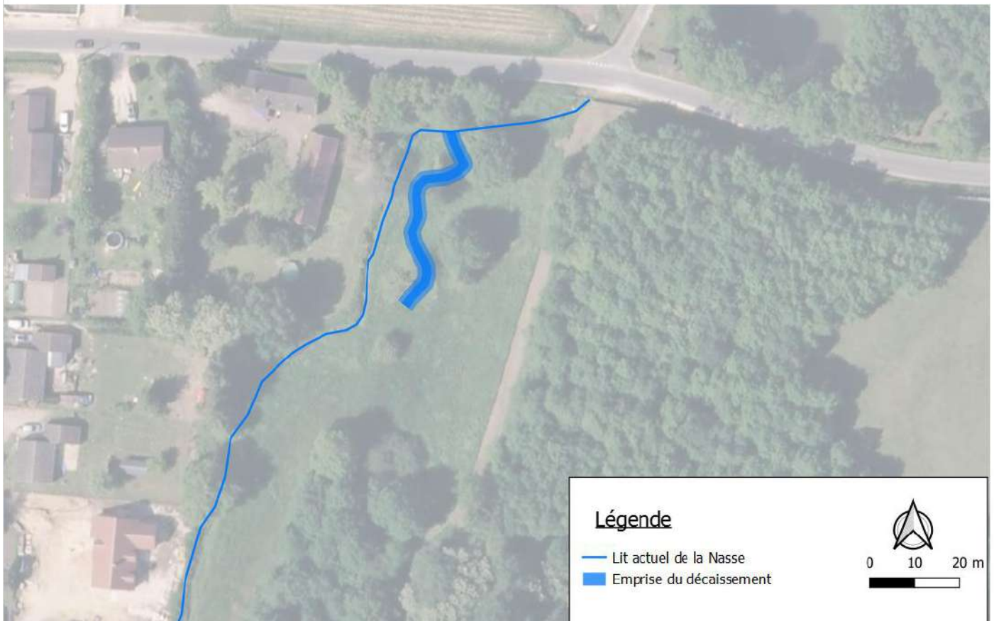
Figure 9 : Emprise du décaissement pour permettre de reconnecter le fond de vallée
